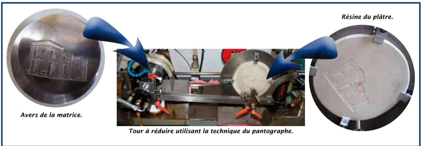
Lorsque le plâtre est terminé, on tire une résine. Le médailleur positionne cette dernière sur un tour à réduire qui utilise la technique du pantographe, pour réaliser la matrice. Le motif apparaît en négatif dans la matrice et à l'échelle souhaitée.
